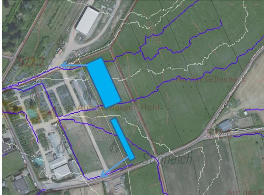
Falls der unter 1a genannte Graben den Oberflächenabfluss in Richtung Baumschule deutlich vermindert, können die hier dargestellten Mulden entsprechend verkleinert werden.
