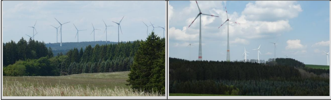
Abb. 5: Eine mehr oder weniger gleichmäßige Verteilung gleich großer Anlagen wie im Bild links wirkt weniger störend als ein „Durcheinander“ verschiedener Größen, Typen und Abstände wie im Bild rechts.
