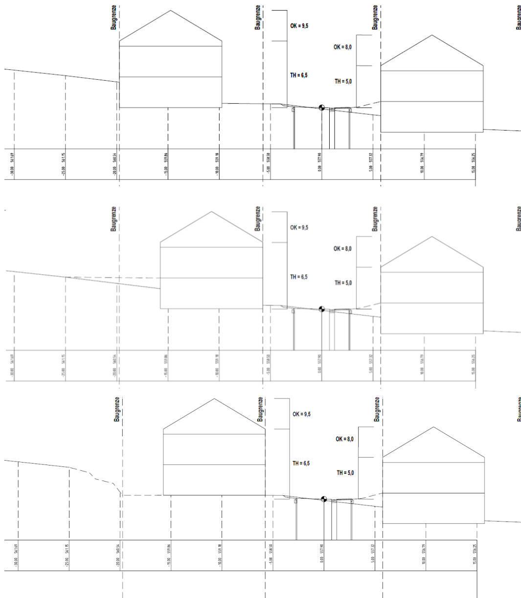
Abbildung 10: Systemschnitt zur Veranschaulichung der Höhenfestsetzungen, Möglichkeiten zur topographieangepassten Bauweise
