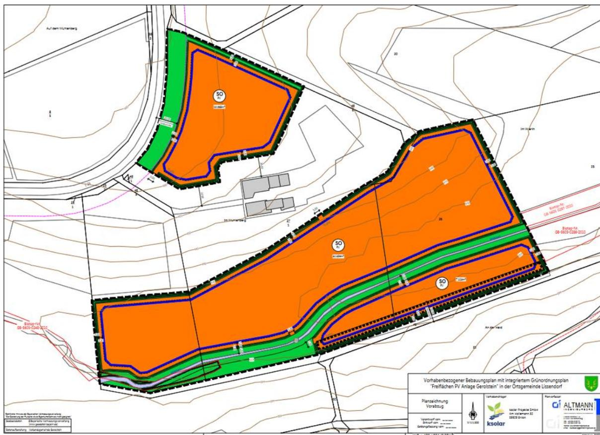
Abbildung 4: Planzeichnung: PV-Fläche in orange, Grünflächen in grün, Baugrenze in blau (entnommen aus Altmann 2023, Anlage 2)
