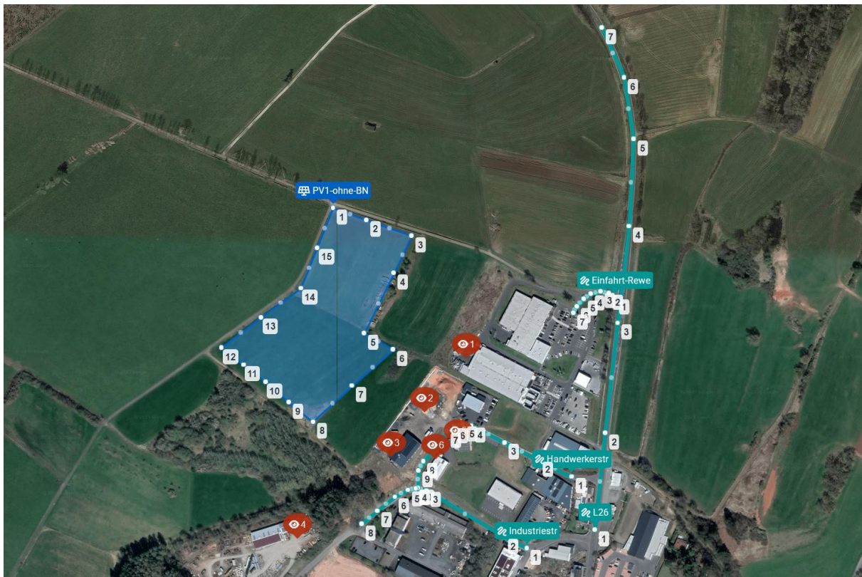
Abbildung 12: PV-Anlage und Immissionsorte in der Simulationssoftware ForgeSolar
