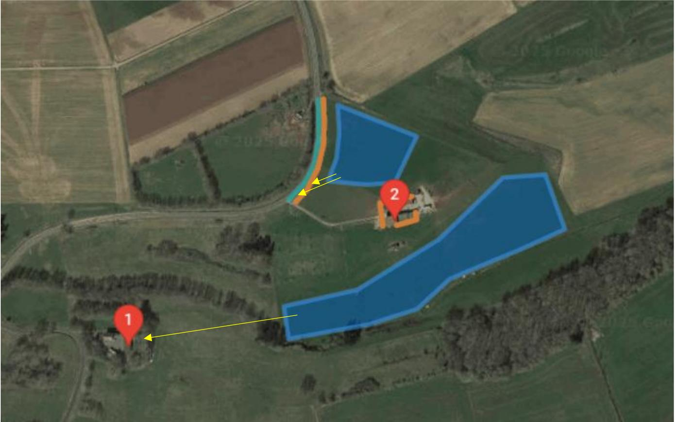
Abbildung 12: Blendungsrisiko bei fehlender Abschirmung der PVA
