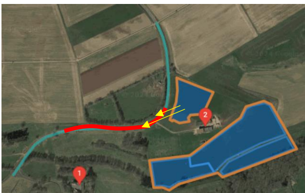
Abbildung 13: Blendungsrisiko bei fehlender Abschirmung der PVA
