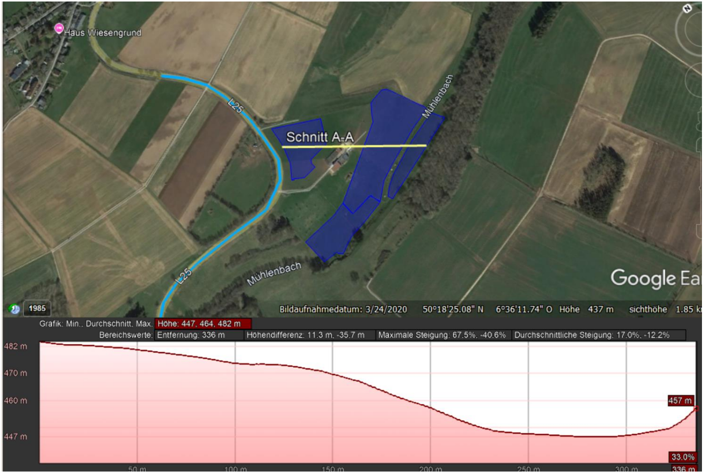
Abbildung 11: Höhenrelief PVA Projektfläche von Nordwest nach Südosten entlang „Schnitt A-A“.
