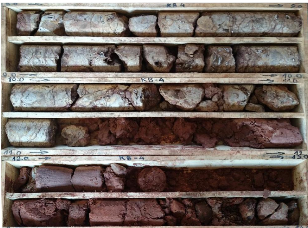
Abb. 5: Bohrkern verkarsteter Dolomitstein aus Kernbohrung GWM 4 an der K 72
